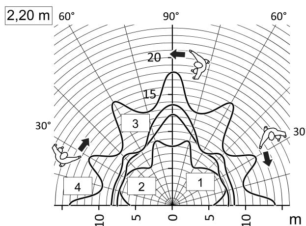
рисунок 5: Дальность действия при тангенциальном направлении движения для накладки
