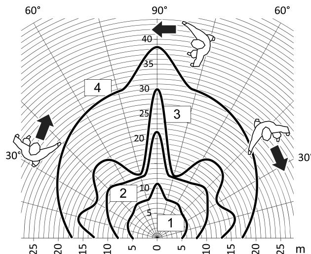
рисунок 2: Дальность действия при тангенциальном направлении движения для накладки
