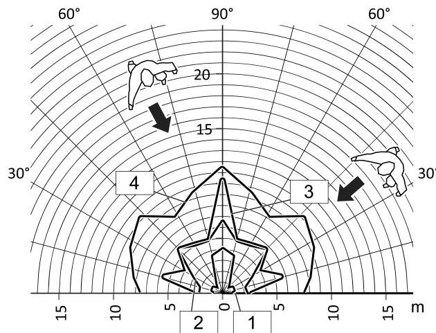
рисунок 3: Дальность действия при радиальном направлении движения для накладки сиг-
