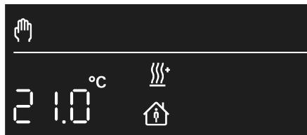
рисунок 3: Индикация заданной температуры в ручном режиме
