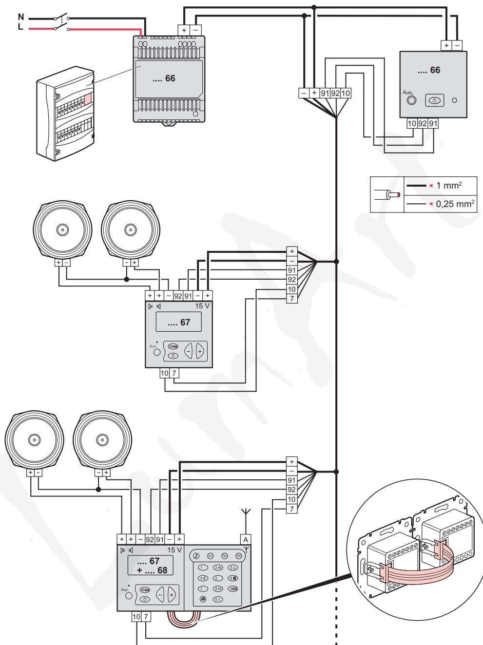
ВСЕПОЛЮСНЫЙ СЕТЕВОЙ ВЫКЛЮЧАТЕЛЬ с контактами, разделенными по крайней мере промежутком, равным 3 мм в каждом полюсе, должен быть установлен в систему энергоснабжения здания
