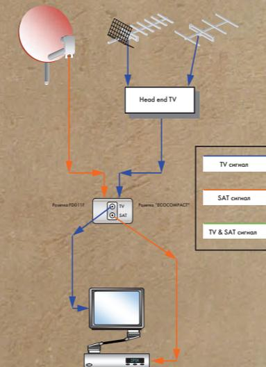
ПРИМЕР ИСПОЛЬЗОВАНИЯ РОЗЕТОК FD506F И FD002F ДЛЯ СОЗДАНИЯ „ПРОХОДНОЙ“ ТВ-СЕТИ И НЕПОСРЕДСТВЕННОГО ПОДКЛЮЧЕНИЯ СПУТНИКОВОГО ТВ
