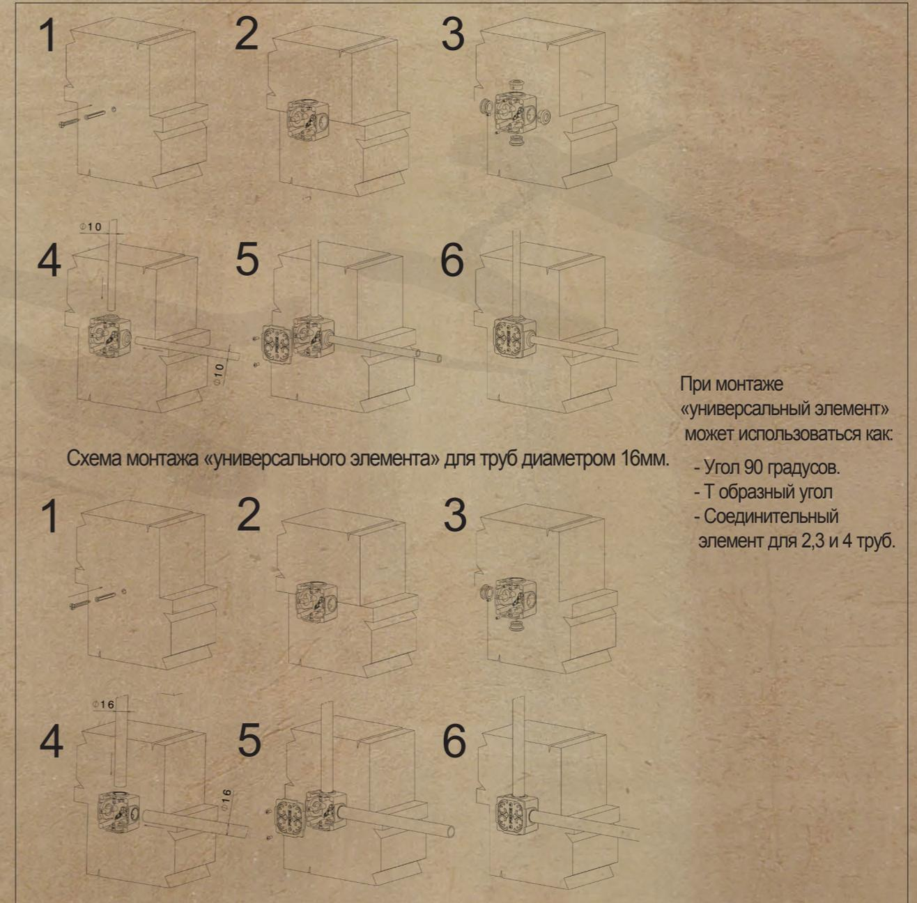
Схема монтажа «универсального элемента» для труб диаметром 16мм.
