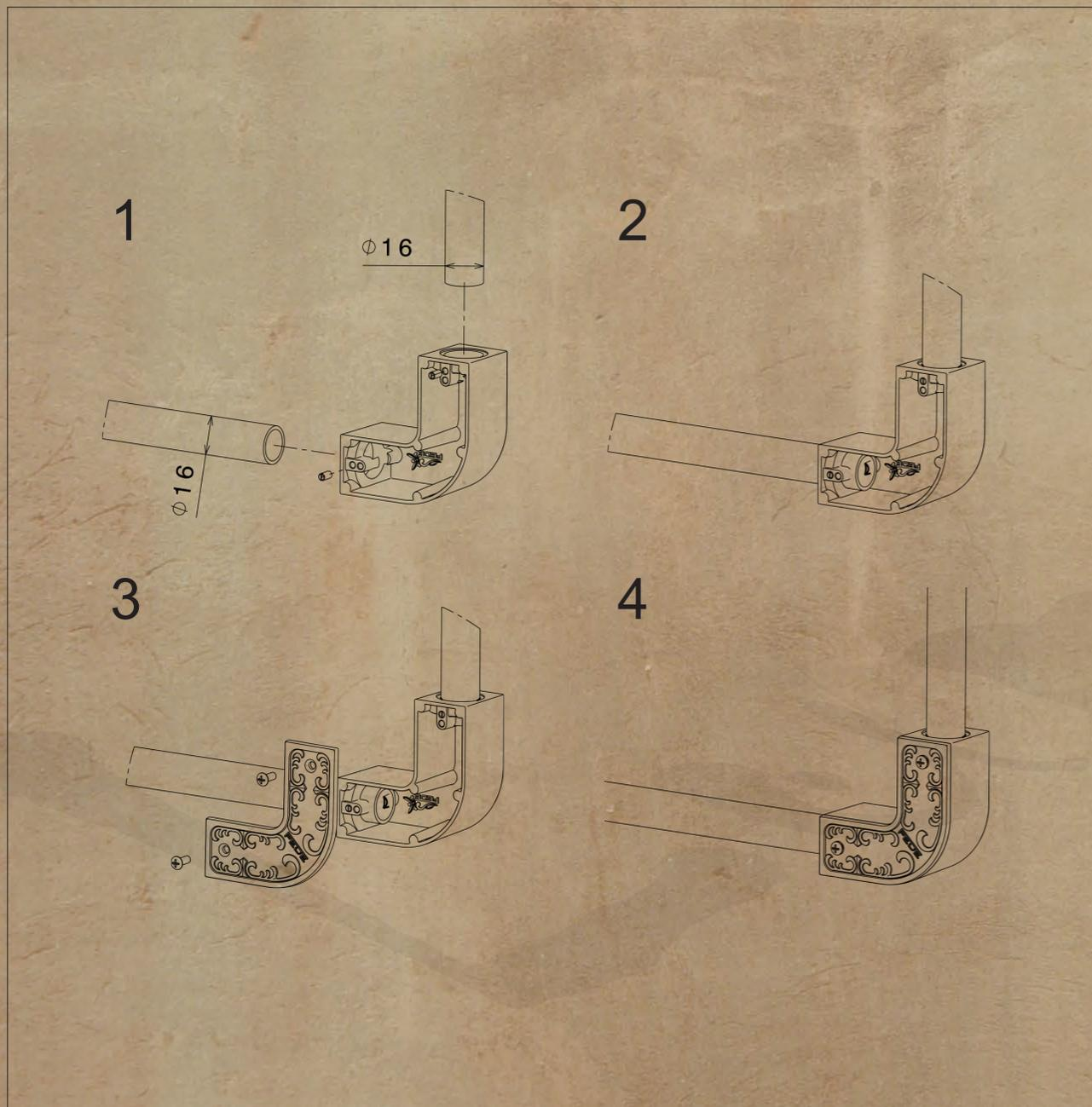
Схема монтажа подвеса люстр для наружного монтажа.
