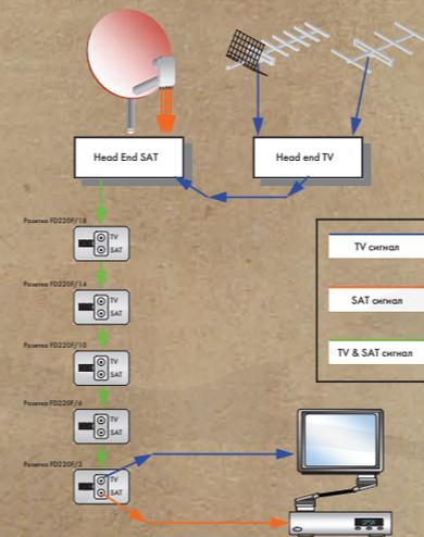
ПРИМЕР ИСПОЛЬЗОВАНИЯ РОЗЕТКИ FD220F ДЛЯ СОЗДАНИЯ СЕТИ ТВ/СПУТНИК ТИПА „ЗВЕЗДА“
