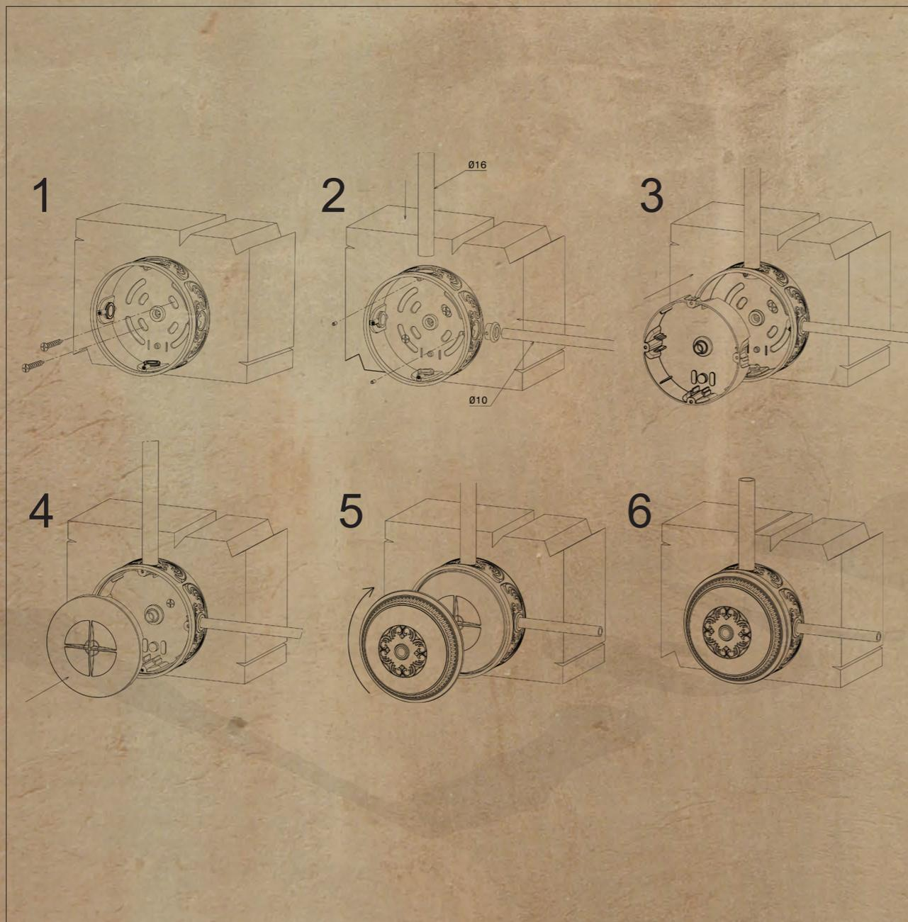
Схема монтажа наружного светильника. В светильник могут устанавливаться, как галогеновые, так и светодиодные лампы.
