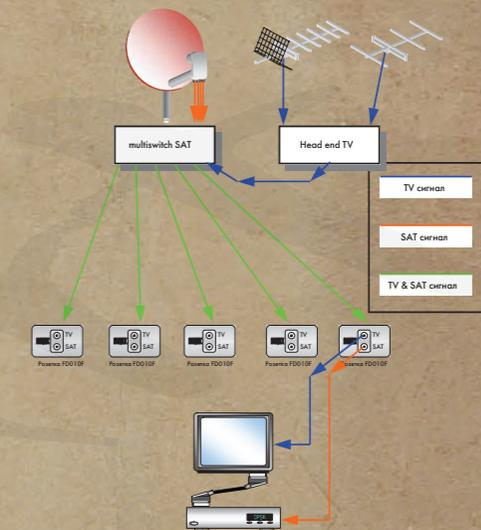
ПРИМЕР ИСПОЛЬЗОВАНИЯ РОЗЕТКИ FD011F ИЛИ КОМПЛЕКТА „ЕКОСОМРАСТ“ ДЛЯ СОЗДАНИЯ СЕТИ ТВ/СПУТНИК
