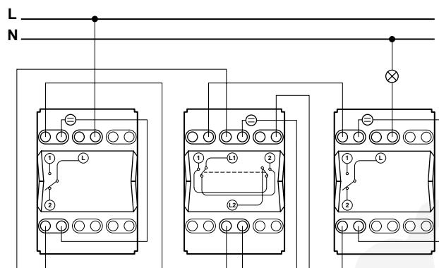
2 выключателя на два направления + 1 промежуточный выключатель с лампами подсветки
