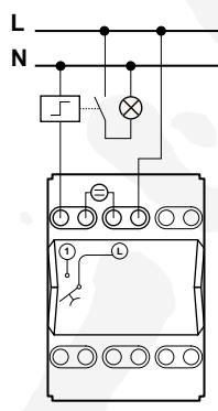
Кнопочный выключатель с лампой местоположения
