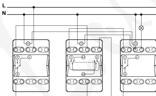
2 выключателя на два направления + 1 промежуточный выключатель
