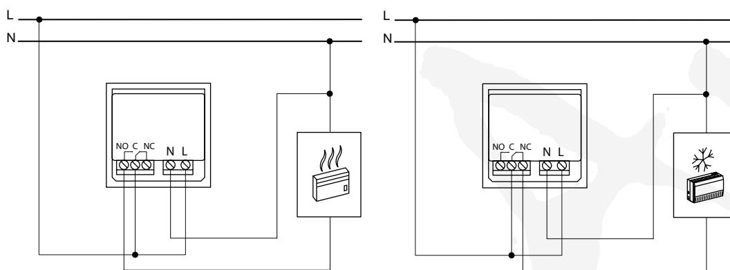
**Термостаты 10А, для пола с внешним датчиком - S5xx507****Подключение**
