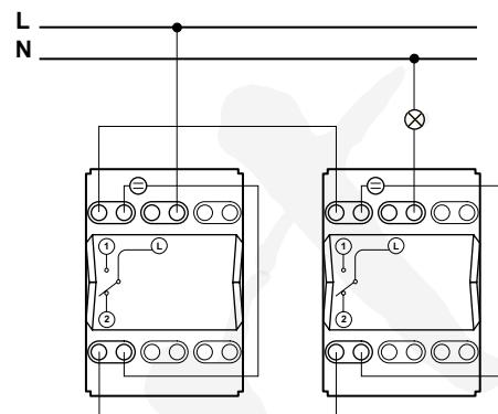
2 выключателя на два направления с лампами подсветки
