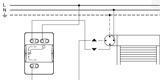
6 А, кнопочный выключатель, 2 клавиши, 3 положения - S5xx207
