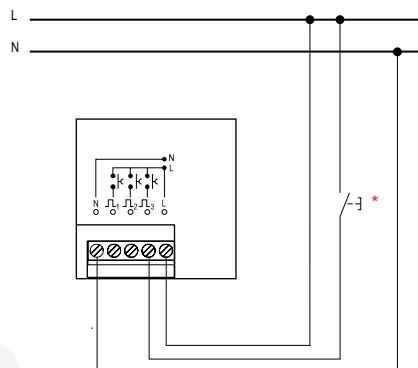
\* Если не подключать параллельно индикаторную лампу, то возможно использование до 10 кнопок, в противном случае, можно установить только 3 кнопки.
