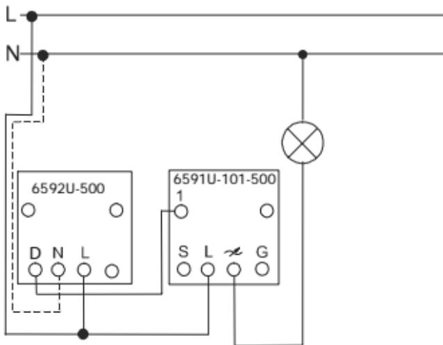
Возможно параллельное подключение макс. 5-и дополнительных приборов управления.
