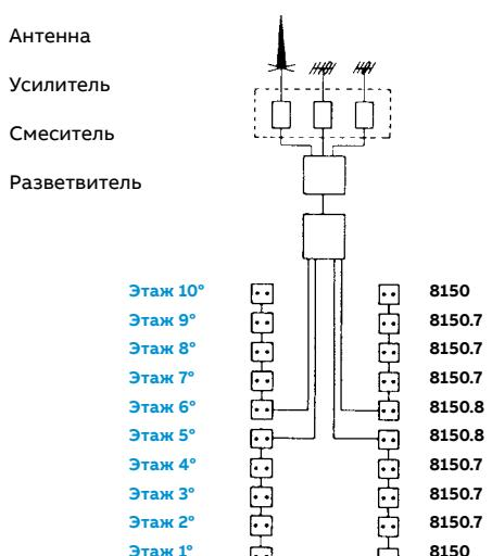
**Пример:** 10 этажей. Этажи разделены на две группы по пять этажей каждая. Розетки распределяются согласно критериям, показанным на схеме подключения MATV для последовательного распределения макс. на 9 этажей. Схема выше может использоваться в зданиях не выше 18 этажей. В зданиях, где этажей больше 18, но меньше 27, необходимо создавать три группы и т. д.
