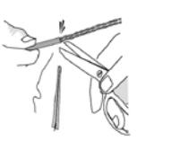
**1.5.** Срежьте сетку (при наличии) и шнур на одном уровне с изоляцией.
