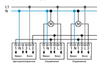
ИК-кнопка 8439.XX и программирующее устройство 6455-101-500 могут управлять группой электромоторов жалюзи, используя добавочные входы (1 и 2) устройства управления жалюзи. С помощью двухполюсного переключателя жалюзи можно двигать жалюзи вручную или активируя датчик на период своего отсутствия.
