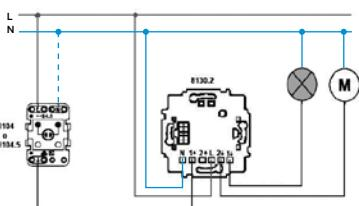
8130.2 с дополнительной кнопкой (8104.5), лампой и мотором. Для управления комбинациями освещения и вентиляторов в ванной комнате.
