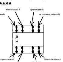
**3.** Толкайте кабели в направлении конца прорези и обрежьте их заподлицо с разъёмом. Используйте инструмент для соединения проводки IBDN 110, BIX, KRONE или аналогичный инструмент типа 110.
