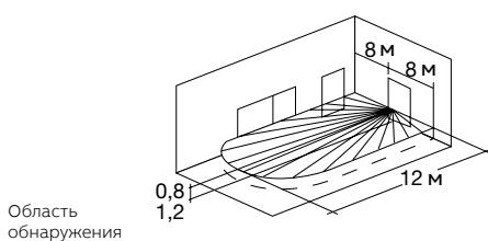
Источники света следует устанавливать вне зоны обнаружения датчиков движения, т. к. тёплые лампы могут быть восприняты датчиком как источник тепла и вызвать ложное срабатывание последнего.
