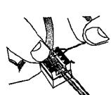
**2а.** Соединение проводов согласно T568A
