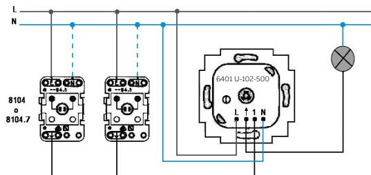
Можно сочетать с клавишой с ИК приёмником, программируемым таймером 6455-101-500 и датчиком присутствия 6813-101-500.
