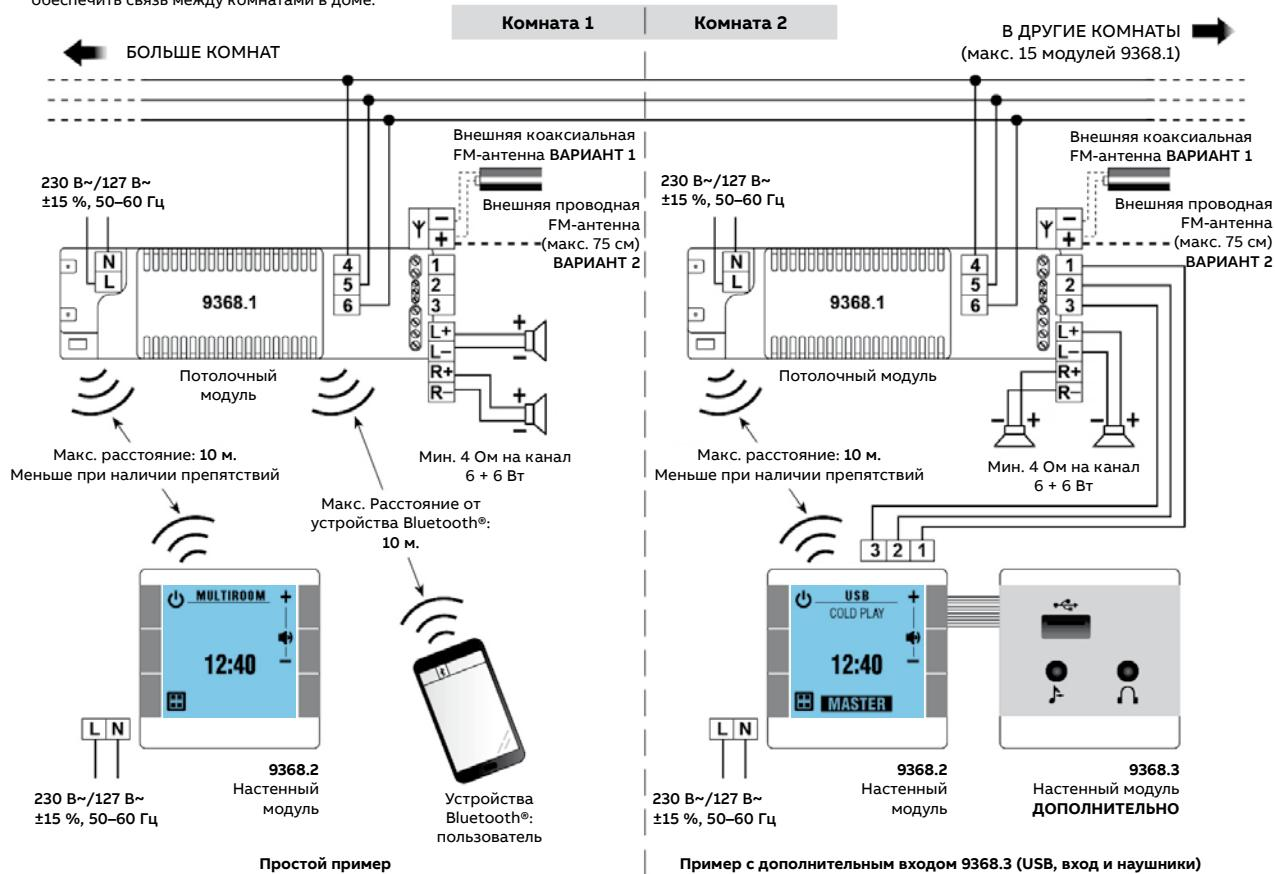
**ПРИМЕЧАНИЕ.** Поскольку эти устройства являются радиочастотными приборами, то во избежание помех не следует устанавливать одинаковые модули или другое РЧ-оборудование, способное создавать помехи, на расстоянии меньше 1 м друг от друга.
