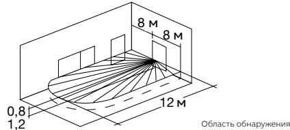
Источники света следует устанавливать вне зоны обнаружения датчиков движения, т. к. тёплые лампы могут быть восприняты датчиком как источник тепла и вызвать ложное срабатывание последнего.
