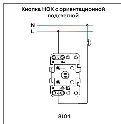
\* Обозначение «» указывает точку подключения лампы ориентационной подсветки.
