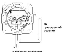
**Важно!** Подключение телевизионных розеток при последовательном распределении должно производиться в соответствии с рисунком слева. Кабель, идущий от предыдущей розетки, подключается к правой клемме, а кабель, идущий к следующей розетке, к левой клемме.
