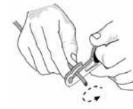
**1.3.** Откройте прибл. 10 см изоляции с помощью режущего шнура или другого инструмента.
