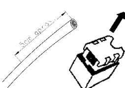
**2.** Извлеките заглушку из разъёма. Снимите прибл. 5 см изоляции и удалите режущий шнур.
